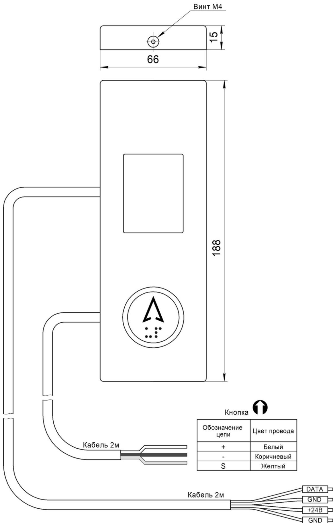
Рис.1 Внешний вид, габаритные и установочные размеры Вызывного поста ВП-1101-1074-15
